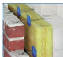
**Применение:** предназначен для установки на имеющееся основание из пористого материала и служит для соединения его со штучной облицовочной кладкой на расстоянии. Для установки необходим специальный адаптер. Диаметр дюбеля 10 мм. Для фиксации теплоизоляционных материалов применяются прижимные шайбы Iso-Clip (не входят в комплект).
