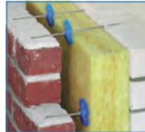
**Применение:** предназначен для соединения несущего основания со штучной облицовочной кладкой на расстоянии. Ø гильзы 8 мм. Для установки необходим обсадный инструмент (ОИ). Для фиксации теплоизоляционных материалов применяются прижимные шайбы Iso-Clip (не входят в комплект).
