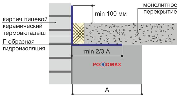
**Гидроизоляция основания** – наиболее важная технологическая операция, поскольку исправить дефекты гидроизоляции в готовом здании практически невозможно. Гидроизоляция основания должна быть выполнена по всему периметру на толщину каменной стены из качественных сертифицированных материалов и находиться выше уровня отмостки здания.
