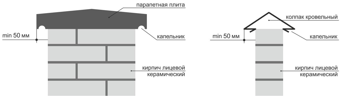
**Кровельное водоотведение** – водосточная система должна быть правильно спроектирована и смонтирована и исключать проникновение атмосферной влаги в стены. Особое внимание необходимо уделять защите от тающего снега и внутренним углам здания.
