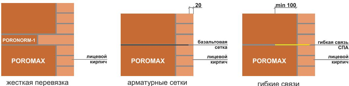
Глубина заделки одиночных связей в растворный шов должна составлять не менее **100 мм** в основном слое из камня **POROMAX**, в облицовочном слое из кирпича **1NF – 90 мм, 0,7NF – 60 мм**. Связи должны отстоять от вертикальных растворных швов не менее **20 мм**.
