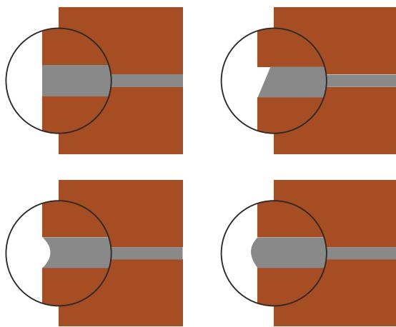
**Растворные швы** – шов должен быть выполнен качественно, без провалов и раковин, и надежно уплотнен. Шов не должен углубляться более чем на 2 мм от лицевой поверхности кирпича и обеспечивать беспрепятственное стекание дождевой воды по стене. Рекомендуемая толщина горизонтального шва - 10 – 12 мм, вертикального - 10 мм. Дождевая вода, стекающая по стене, не приводит к высолам, поскольку быстро испаряется и не проникает в кладку.
