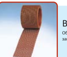
Фигураль Плюс Имитационный аэроэлемент конька/хребта, обеспечивающий за счет уникального волнообразного профиля, вентиляцию подкровельного пространства и защиту от попадания воды и снега. Сверхтонкий рулон 0,28-0,32 x 5 м, возможность растяжения до 50%.
