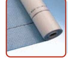
Ютафол D110 Обеспечивает гидроизоляцию кровли. Необходимо организовать вентиляционный зазор между лентой и утеплителем. Паропроницаемость >15 г/м 2 /24 ч.
